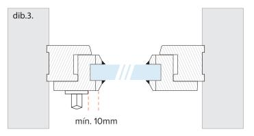
Sistema con cajón de PVC, guías laterales, montaje no invasivo en la hoja de la ventana (pegado)
