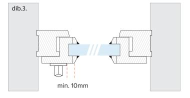
Sistema con cajón de aluminio, guías laterales, montaje en la hoja de la ventana (apretado)
