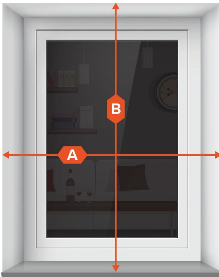
**Mide el ancho y el alto del vano del hueco de la ventana (los bordes exteriores del hueco, hasta el alféizar de la ventana).**
